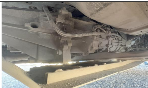
Obrázok č. 18. Prevodovka a prídavná prevodovka [9]
