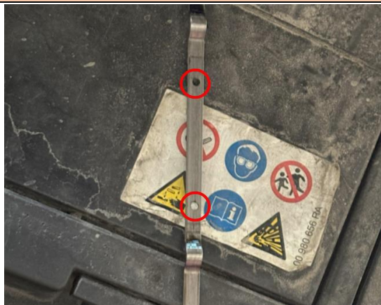
Obrázok č. 16. Mierka výšky hladiny oleja [9]
