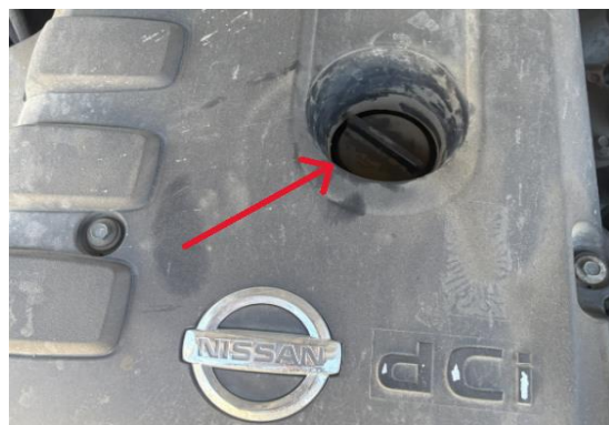
Obrázok č. 17. Hrdlo na nalievanie motorového oleja [9]
