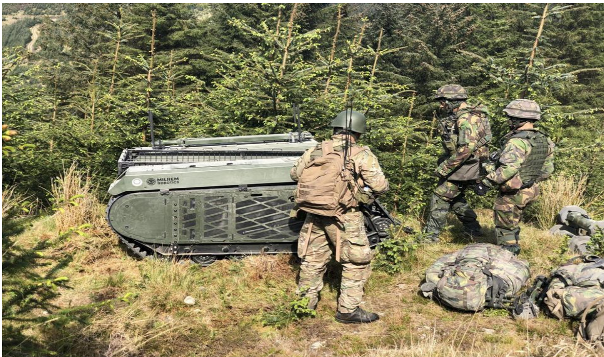
Obrázok 4. Logistický UGV THEMIS estónskej spoločnosti Milrem Robotics na prepravu nákladov v náročnom teréne
