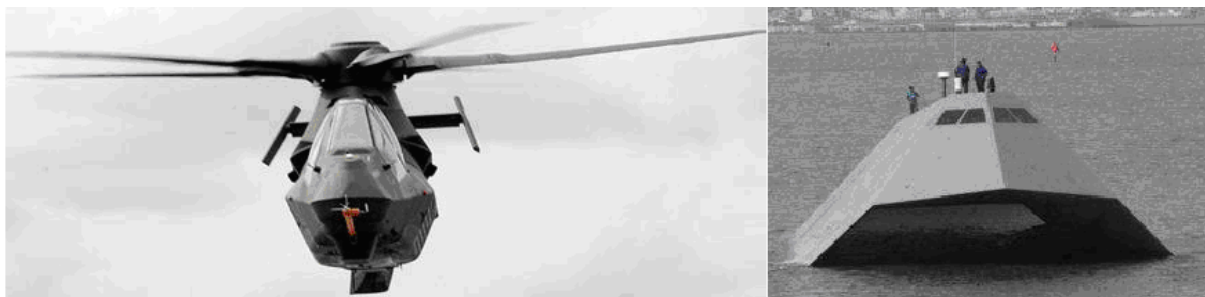
Obrázok 4 - Realizácia STEALTH technológie fazetovaných plôch u vrtuľníka a lode
