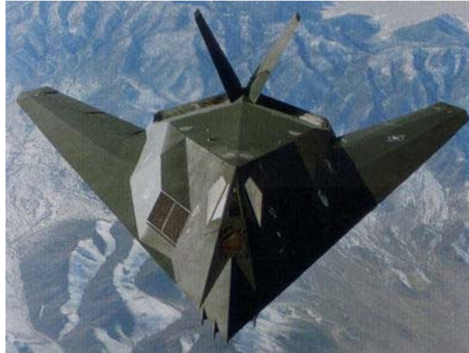
Obrázok 3 - Realizácia STEALTH technológie pomocou fazetovaných plôch na stíhacom bombardovacom lietadle F-117
